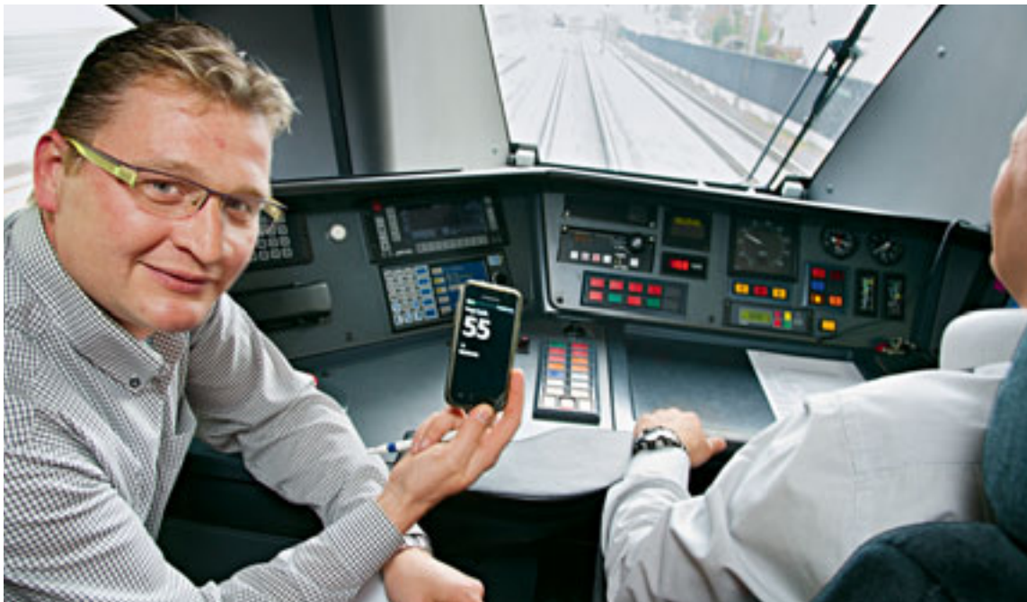
Sparsamer fahren und das Netz noch besser nutzen: Lokomotivführer Andreas Hofer mit Smartphone, das im Testbetrieb die Fahrempfehlungen empfängt
