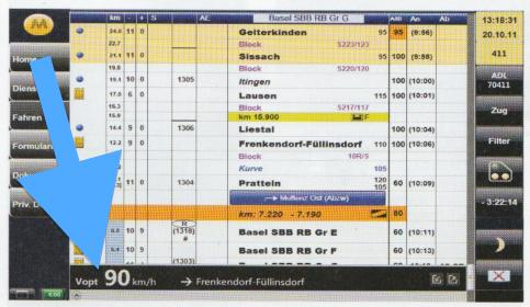
Beispiel eines ADL-Ausgabekanals im Lokführerstand. Die Fahrempfehlung ist in der Oberfläche des elektronischen Lokführerassistenten «LEA» der SBB integriert. ADL bedient auch Endgeräte wie CAB-Radio oder Smartphones. Bild: SBB
