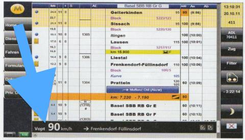
Beispiel eines ADL-Ausgabekanals im Lokführerstand. Die Fahrempfehlung ist in der Oberfläche des elektronischen Lokführerassistenten «LEA» der SBB integriert. ADL bedient auch Endgeräte wie CAB-Radio oder Smartphones.
